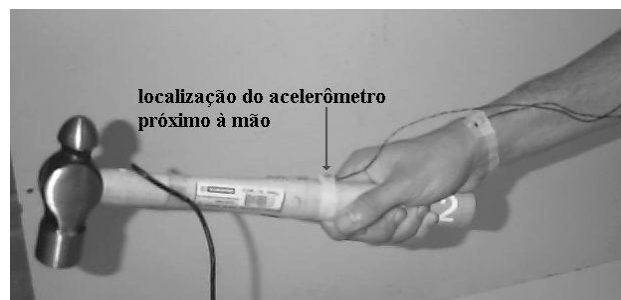
Figura 2 - Local de fixação do mini acelerômetro sobre o cabo da ferramenta.
